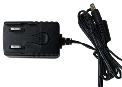
AD-SA1205WD P# 7679-00420 Fonte de alimentação externa para plugue intercambiável 12V DC, 0.5A sem seu plugue (Mundo. Em seguida, adicione o plugue correspondente ao seu país)
